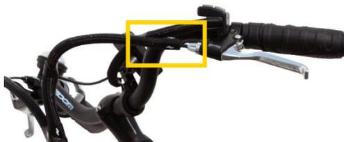
Desserrer le serre-câble et tirer sur le câble jusqu'à ce que les patins touchent la jante. Resserrer le serre-câble (une attention particulière est à apporter à chaque extrémité de la gaine qui doit entrer sans forcer dans le logement de chaque embout rigide, côté poignée de frein et V-Brake.)
